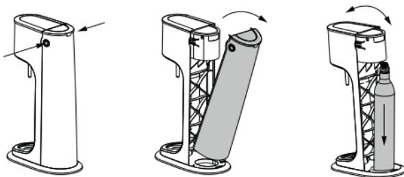
Vinkla kolsyremaskinen framåt och för ner kolsyreflaskan genom öppningen i botten av maskinen, så att kolsyreflaskan står på underlaget. Vinkla sedan tillbaka kolsyremaskinen så att ovandelen av maskinen lutar mot kolsyreflaskans gänga.
