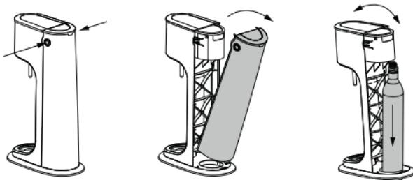
Vipp kullsyremaskinen fremover og før gassflasken ned gjennom åpningen i bunnen av maskinen, slik at gassflasken står på underlaget. Deretter vipper du kullsyremaskinen tilbake, slik at overdelen av maskinen heller mot gassflaskens gjenger.
