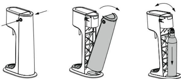
Kallista hiiilihapotuslaitetta eteenpäin ja aseta hiiidioksidipullo laitteen pohjassa olevaan aukkoon niin, että pullo jää pystyn laitteen pohjalle. Käännä laite takaisin pystyasentoon niin, että laitteen yläosa nojaa hiiidioksidipullon kierteistä venttiiliä vasten.
