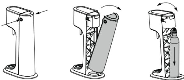
Hold danskvandsmaskinen i en vinkel fremover og før kulsyrepatoronen ned gennem åbningen i bunden af maskinen, så kulsyrepatoronen står på underlaget. Vip derefter danskvandsmaskinen tilbage, så overdelen af maskinen læner ind mod kulsyrepatorons gevind.
